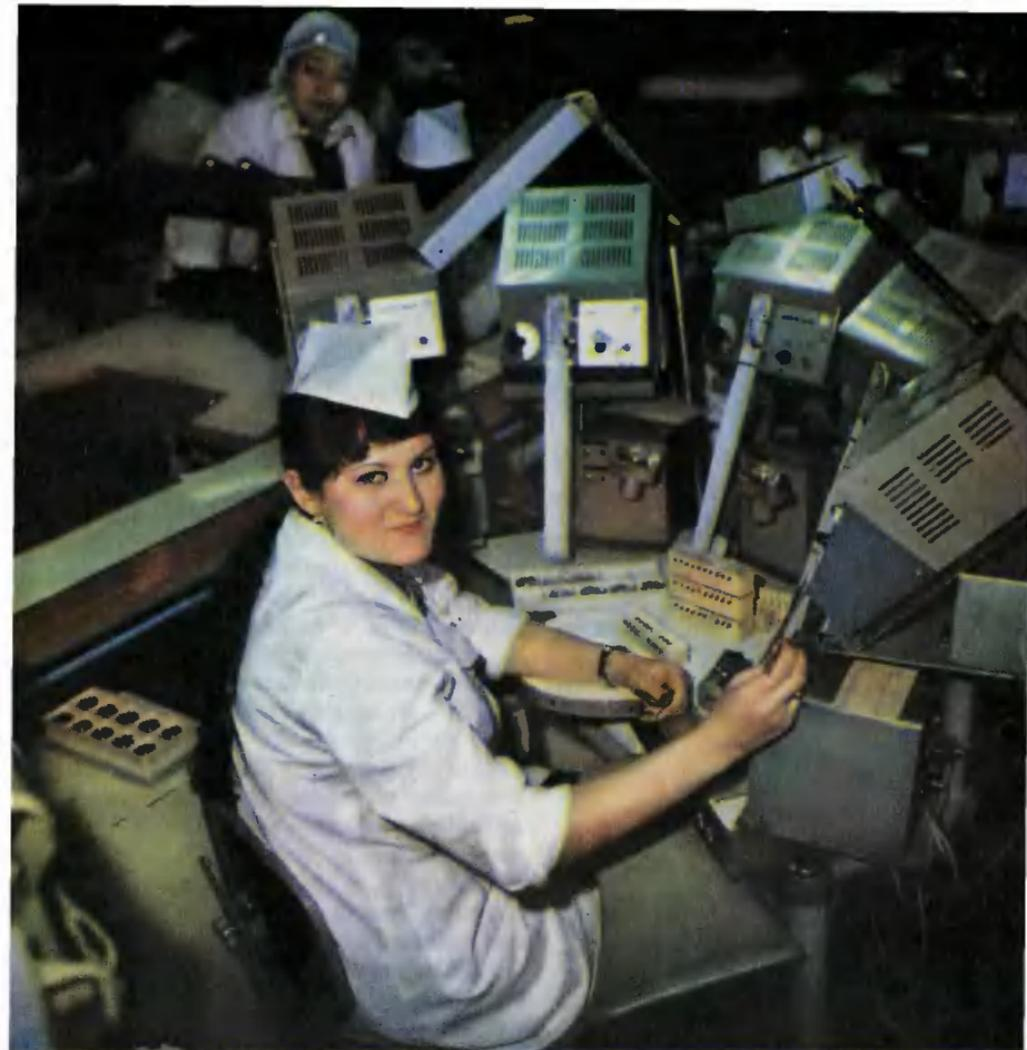
**Эта девушка регулирует точность хода пяти часов одновременно. Сразу видно — работа интересная.**
